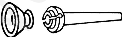
Gummi-Kabeltülle und Kabelschlauch
