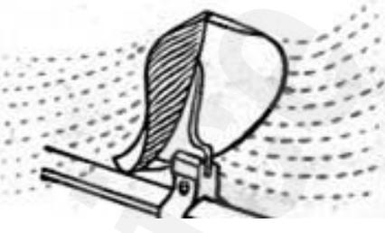
Der durchsichtige **Wirbulator** wird wenigstens 65cm von der Windschutzscheibe entfernt unter die Fronthaubenzierleiste geklemmt. Insekten, Staub und Schnee werden mit seiner Hilfe umgelenkt.
