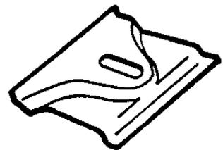
Halteplatte zur Batteriebefestigung
