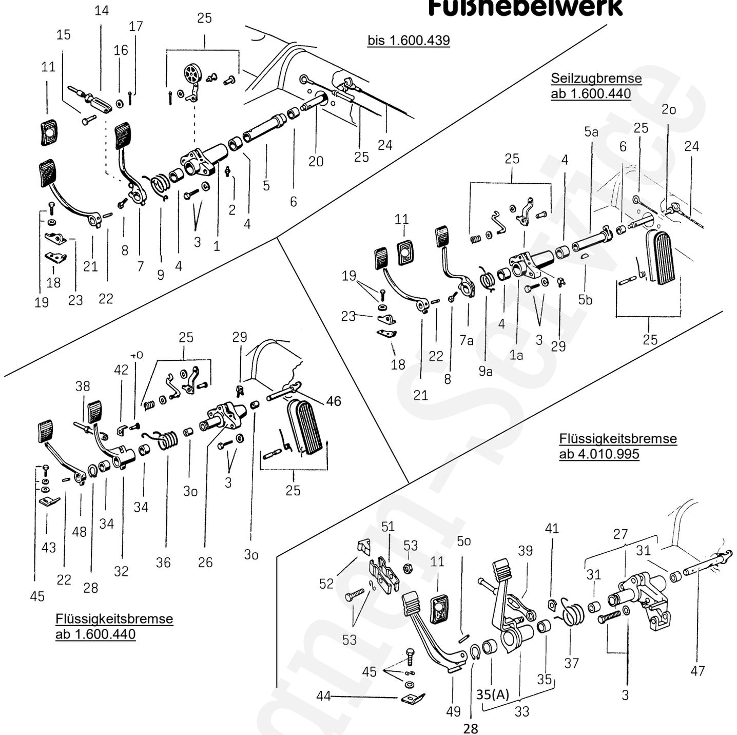
**Fußhebelwerkteile** a) nur für Flüssigkeitsbremse bis 1.600.439 = EX am Ende der Zeile
