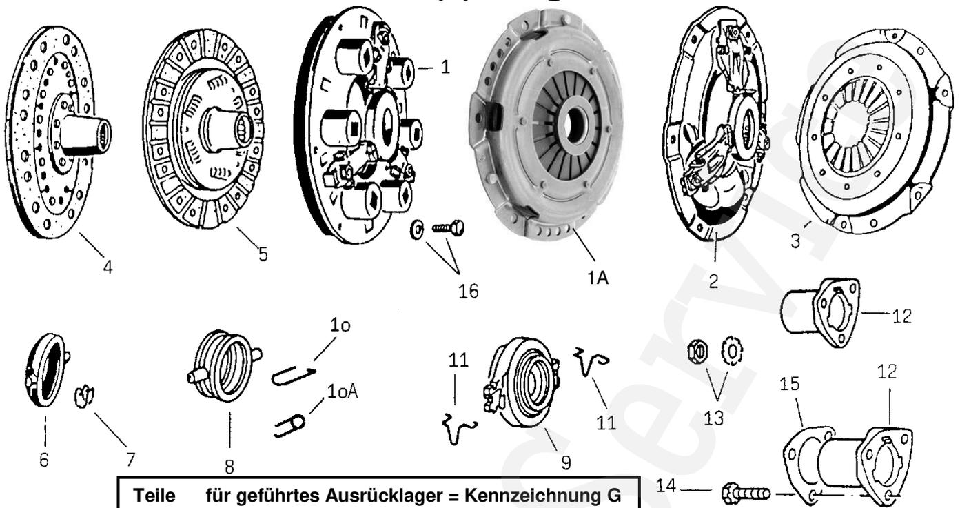
Teile für geführtes Ausrücklager = Kennzeichnung G
