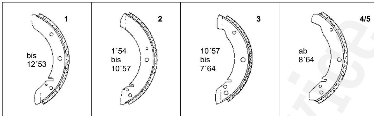
\* **ÜBERDICKE** wird benötigt, wenn die Bremstrommeln Ihres Käfers schon einmal ausgedreht wurden
